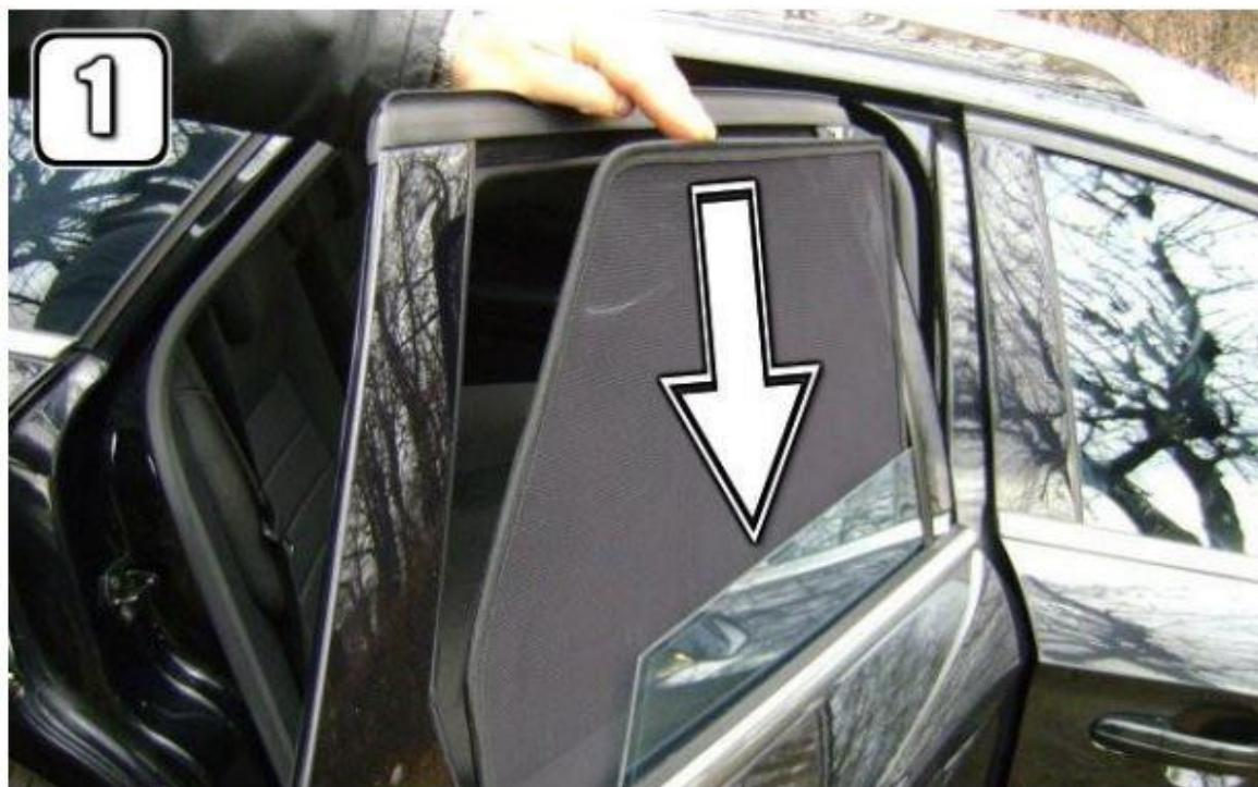
Zaslonkę wsuwamy od strony zewnętrznej drzwi przy otwartym oknie. **Fot 1.** La cortinilla introducimos por la parte exterior de la puerta con la ventanilla bajada. **Fot.1** .Die Sonnenschutzteile schieben wir von der außenseite der Tür bei offenem Fenster . **Fot.1**
